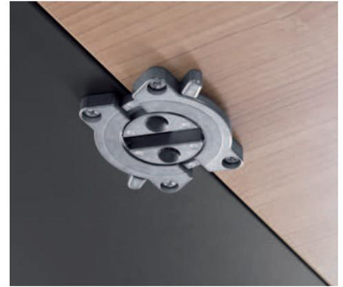
Auf den Unterseiten der Tisch- und Verbindungsplatten befinden sich spezielle Metallklammern, mit denen man die Tische einfach verbinden und gleichzeitig die Arbeitsfläche vergrößern kann. Auf den Plattenoberflächen der Verbindungsplatten befinden sich vier zusätzliche Metallelemente, welche die Einpassung in die Plattenecken erleichtern. Dieses intuitive, modulare Konzept ermöglicht je nach Bedarf die einfache Schaffung beliebiger Tischkonstellationen.
